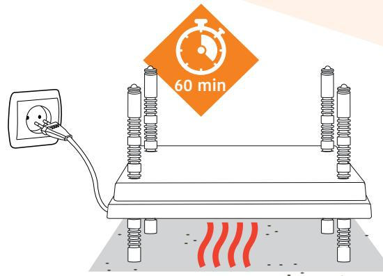
Als alle Füße auf die gleiche Höhe eingestellt sind, kann die Wärmeplatte aufgestellt werden und anschließend an das Stromnetz angeschlossen werden. Die Kontrolle-LED wird jetzt aufleuchten. Nach ungefähr 60 Minuten wird die ideale Temperatur erreicht sein und können die Küken unter der Wärmeplatte Platz nehmen.
