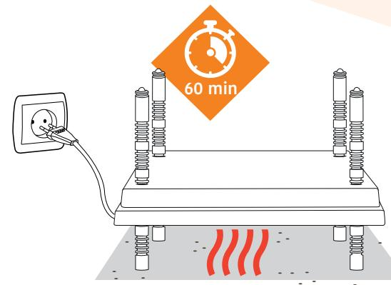
Une fois tous les pieds sont ajusté à la hauteur juste, le panneau chauffant peut être positionné et, enfin, connecté à la puissance. L'indicateur LED va s'allumer. Depuis environ 60 minutes la température idéale sera atteinte et les poussins peuvent s'asseoir sous le panneau chauffant.
